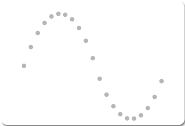
► 图 17. (左)表示正弦波的一串样点；(右)重建的正弦波。
